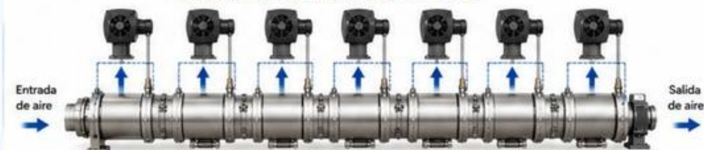
Distribución de ventiladores de enfriamiento
