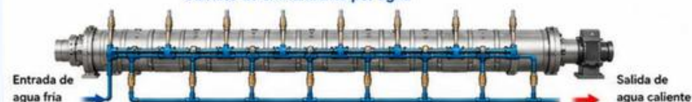
Circuito de enfriamiento por agua
