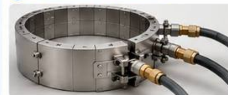
Circuito de enfriamiento por agua
